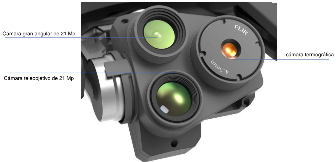
Higo. 11: Módulo de triple cámara
