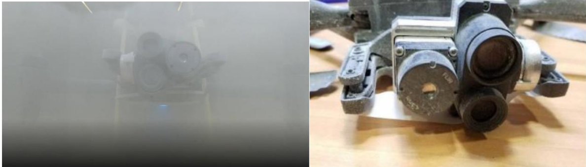
Fig. 7: Prueba IP5X (arena)
