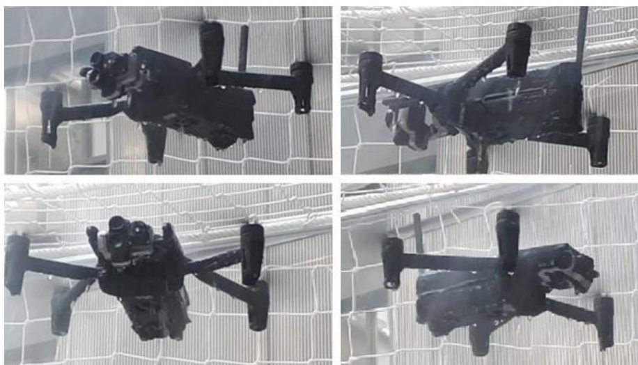
Fig. 6: Prueba IPX3 (rociando 10 litros por minuto)
